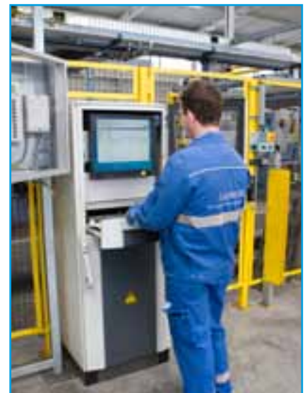
Prüfung der Schweißparameter
