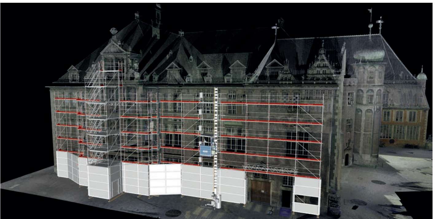
Das gesamte Rathaus wurde mithilfe eines 3D-Laserscans sehr detailliert erfasst und in Form eines digitalen Zwillings für die zuverlässige Gerüstplanung und Materiallogistik in der Bremer Innenstadt herangezogen.
