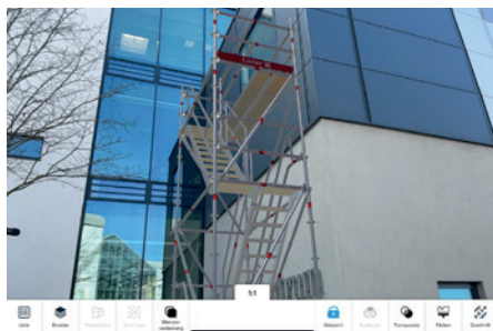
Platzieren des virtuellen Gerüsts per Augmented Reality in der realen Umgebung
