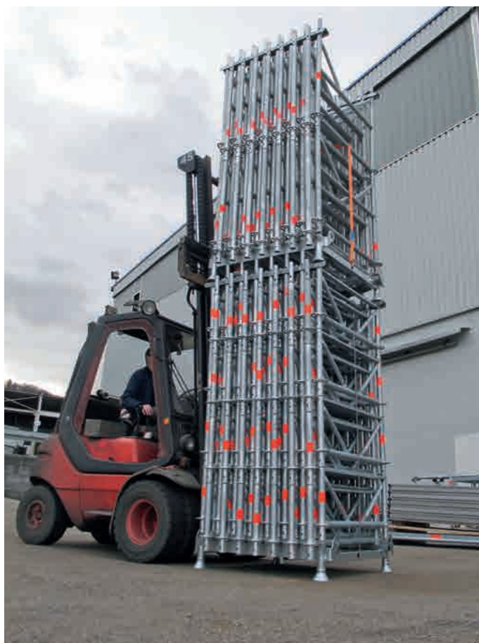
Befüllte, gestapelte TG 60-Rahmenpaletten für den Transport mit dem Gabelstapler
