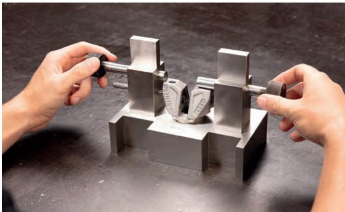
Maß- und Funktionsprüfung der Halbfertigteile
