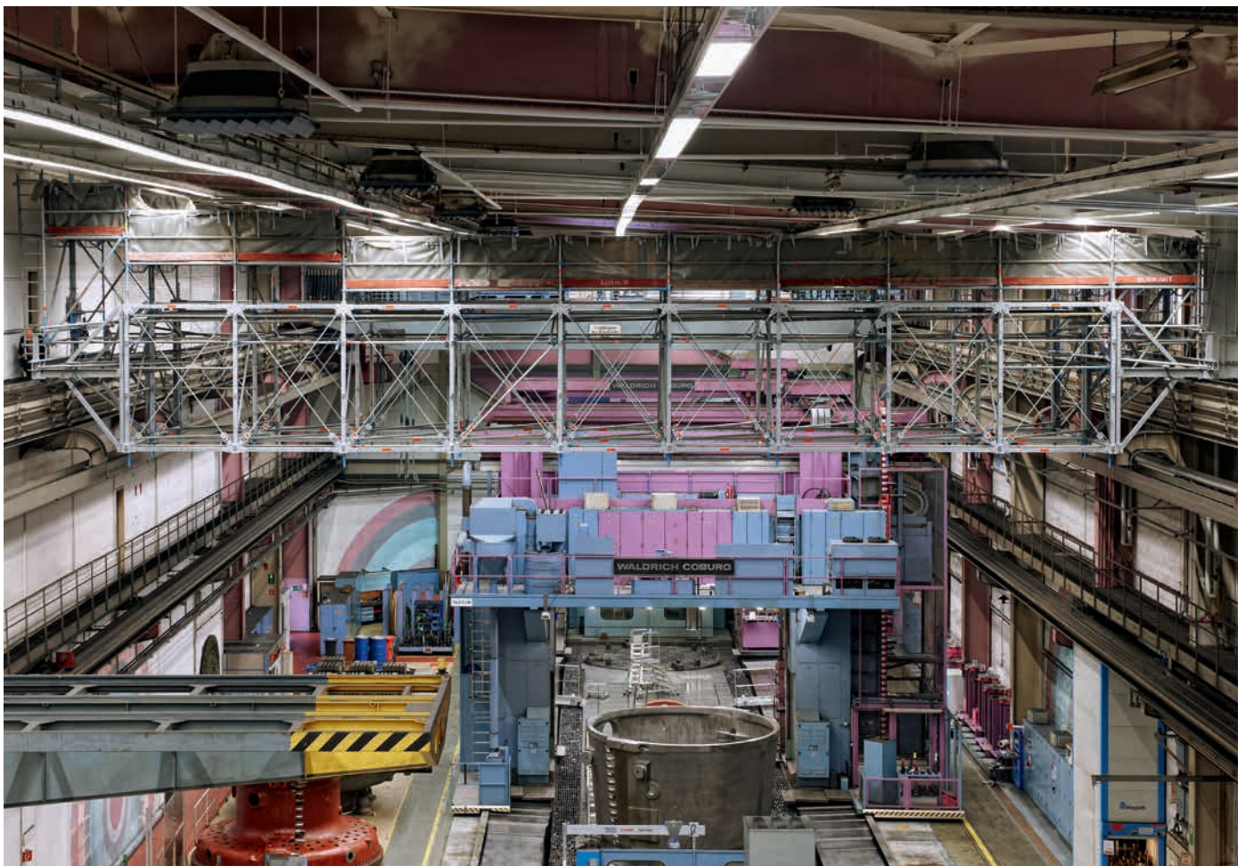
Verfahrbare Arbeitsplattform an einer Hallendecke – die Bodenfläche bleibt frei, wodurch der Betrieb fortgesetzt werden kann. Die Verfahbarkeit verringert den Materialeinsatz deutlich.
