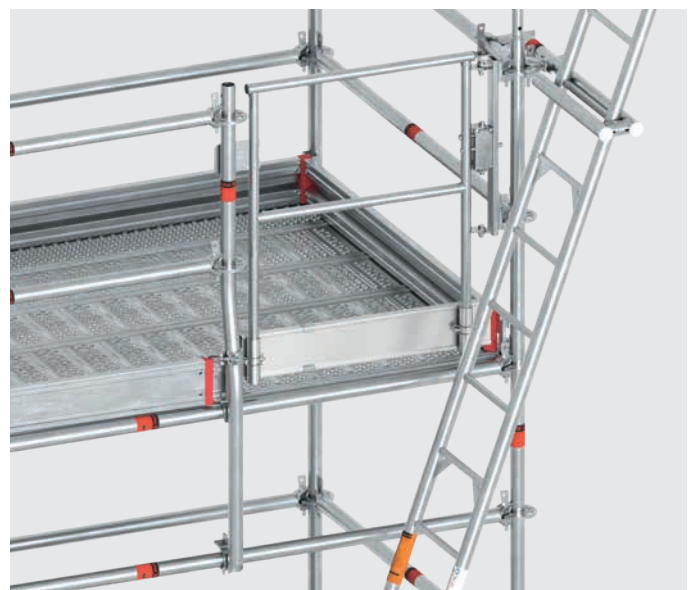
Außenliegender Leiternaufstieg mit Gerüstanlegeleiter, Leiternhalter und selbst-schließender Schwenktür
